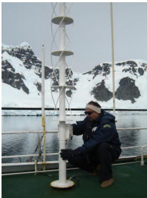
**Figura 8. Troca do pré-amplificador do sistema “MTR” na antena helicoidal no Tijupá do NApOc Ary Rongel, em 19/janeiro/2005**
