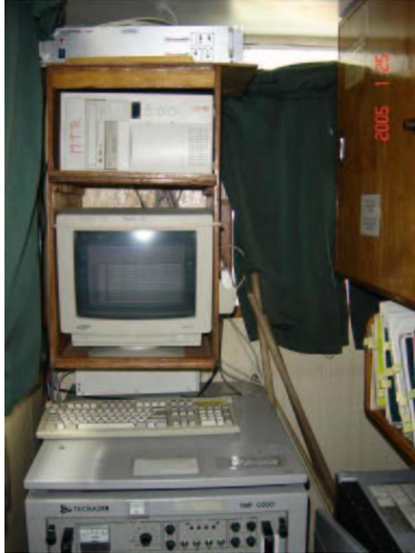
**Figura 9. Receptor VHF de transmissões dos “MTRs” instalado em ??/Jan/2005 no passadiço do NApOc Ary Rongel para subsituir o que apresentou defeito na Fase II.**
