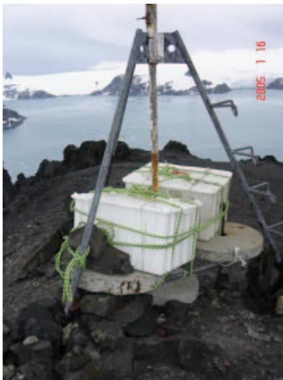
**Figura 1:** Estação Automática do Morro da Cruz após ser desmontada na madrugada de 16/Jan/2004. A caixa no 1º. plano contém a bateria e a em 2º. o sistema de aquisição de dados, painel solar, sensores, etc. As caixas aguardam vôo de helicóptero para o Navio.
