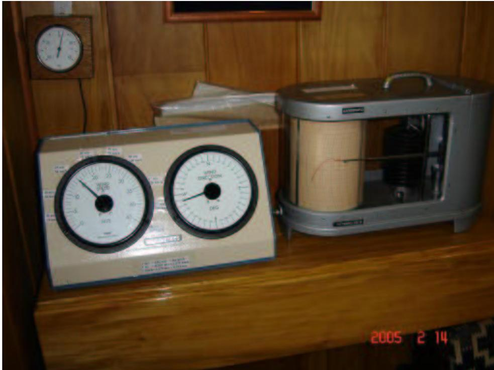
**Figura 11. Mostrador de vento Qualimetrics na sala-de-estar da Estação Ferraz, após manutenção e substituição do sensor na torre da meteorologia.**
