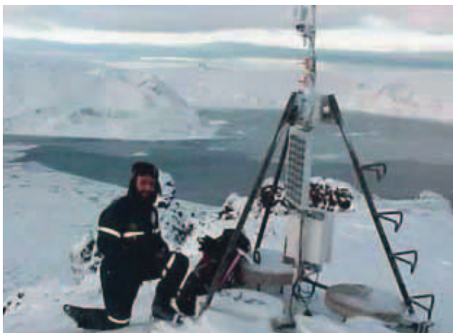
Figura 2: Manutenção AWS. As condições de trabalho, como neste caso do Morro da Cruz, Ilha rei George, impõem dificuldades e cuidados sérios no trabalho.
