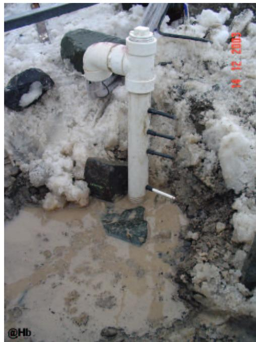
Foto 2 - Detalhe do Sensor de Temperatura do Solo antes da instalação.
