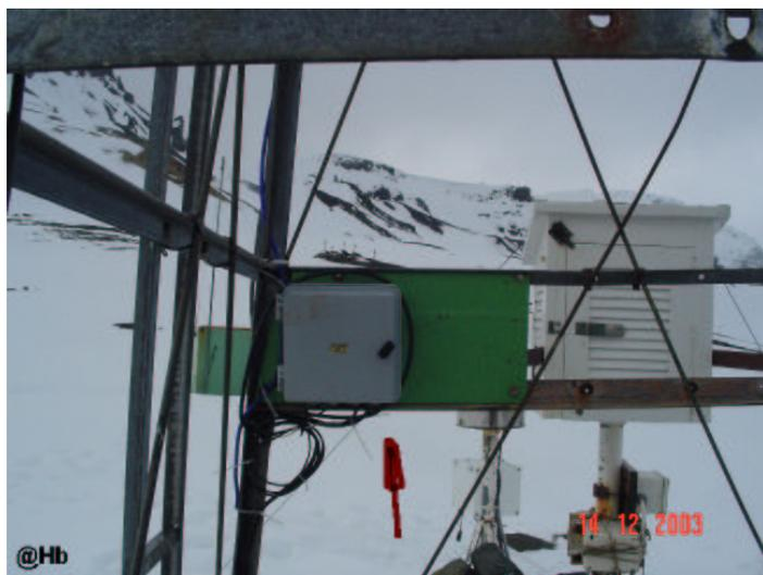
Foto 4 - Nova caixa para interligação da cabeção do Sensor de Temperatura do Solo ao Sistema de Aquisição "DataLogger" no Módulo de "Meteorologia". A caixa foi fixada na lateral "N" da base da antiga Torre dos Ingleses.
