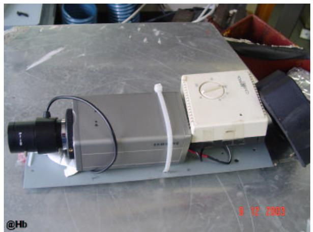
Foto 7 - Detalhe da frente da caixa metálica com sistema de aquecimento e ventoinha externa.
