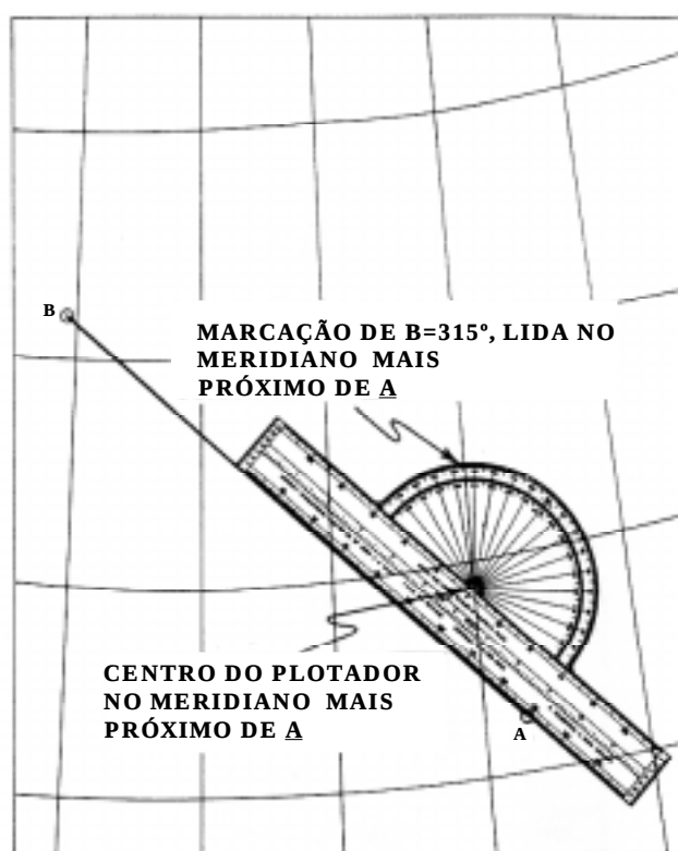
Figura 41.6 b – Medida de Marcação na Carta Conforme de Lambert
